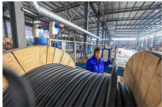
2024年12月16日,洛阳二缆电器线缆有限公司生产车间内轰鸣声不断,经过拉丝、绞线、成缆等十几道工序后,一根根基建阻燃耐火电力电缆被生产出来。该公司市场部业务员正忙着对接纷至沓来的订单;仓库里,一排排成品电缆整齐摆放,即将发往全国各地。
