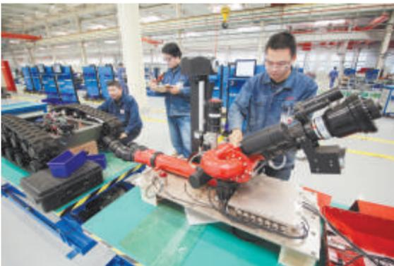
中信重工高端电液智能控制装备制造项目现场,工人们正在加紧组装消防机器人
